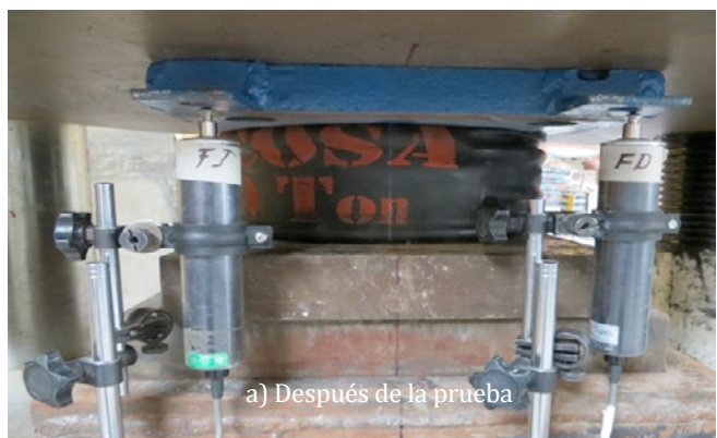
Figura 3. Celda de deformación de material polimérico.
