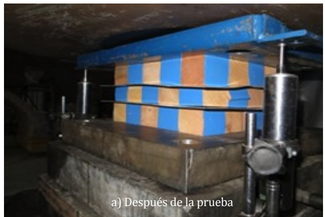
Figura 2. Celda de deformación de madera (tipo caobilla).
