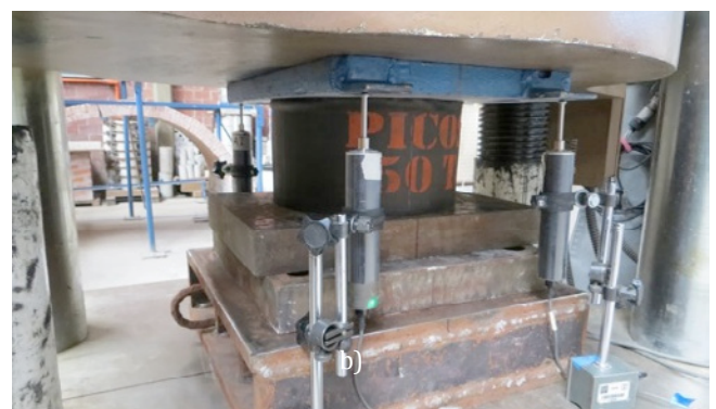
Figura 1. a) Arreglo de 3 niveles de 5×4 cubos de madera (≈ 50 t de capacidad), b) Cilindro polimérico de 50 t de capacidad.
