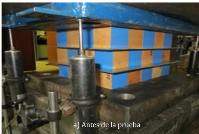
Figura 2. Celda de deformación de madera (tipo caobilla).
