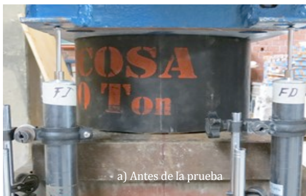
Figura 3. Celda de deformación de material polimérico.
