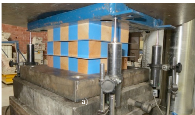
Figura 1. a) Arreglo de 3 niveles de 5×4 cubos de madera (≈ 50 t de capacidad), b) Cilindro polimérico de 50 t de capacidad.
