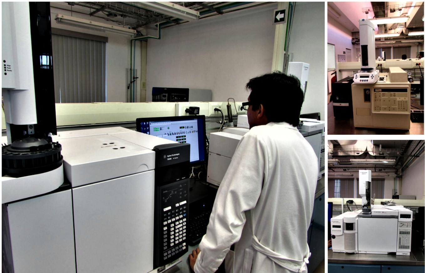
Figura 2. Equipos de cromatografía de gases para el análisis de los contaminantes en fase gaseosa
