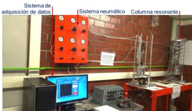
Figura 2. Equipo resonante
