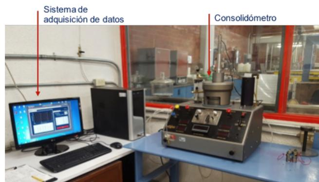
Figura 4. Consolidómetro neumático
