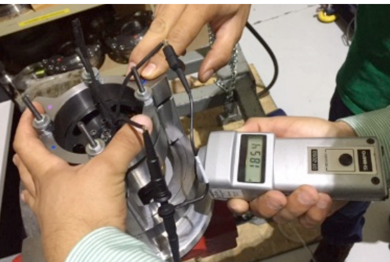
Figura 4. Registro de vibraciones de la microturbina
