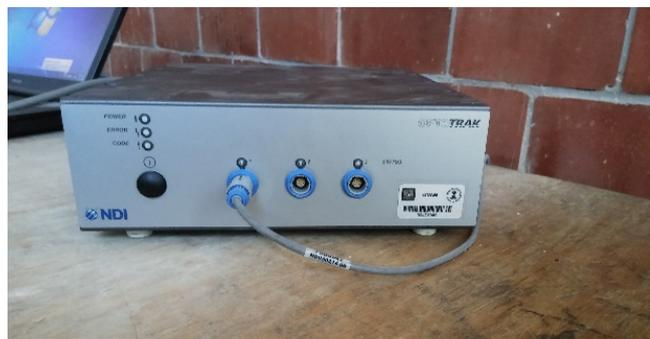
Figura 1. Controlador NDI del equipo de captura OPTOTRAK
