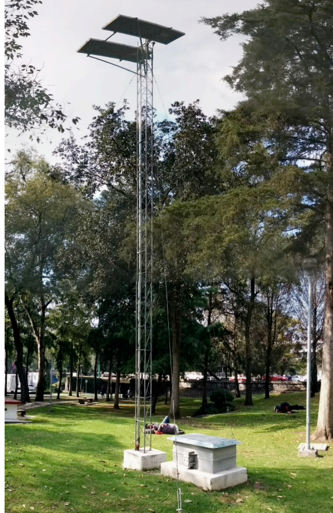
Figura 2. Estación acelerográfica autónoma típica de campo libre
