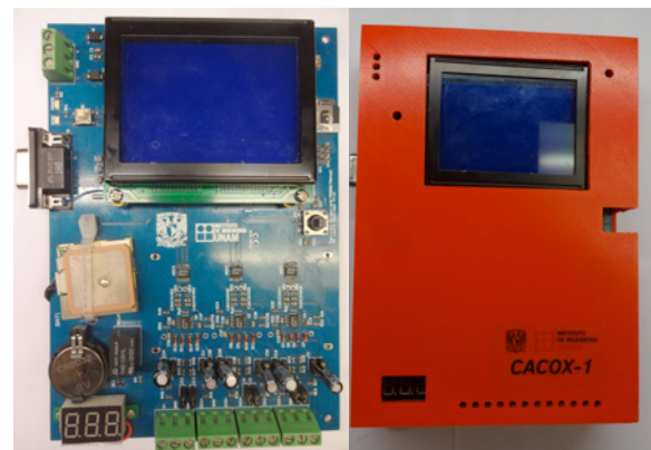
Figura 1. Tarjeta de adquisición y tarjeta de adquisición con su carcasa, respectivamente
