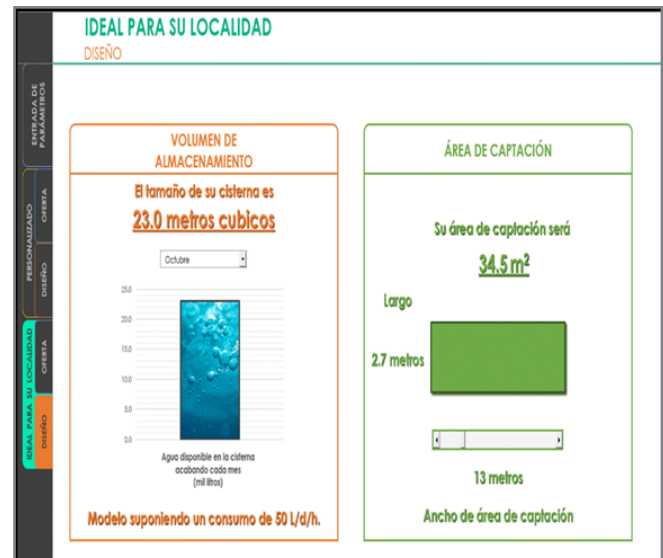
Figura 2. Diseño propuesto con especificación de área de captación y volumen de la cisterna
