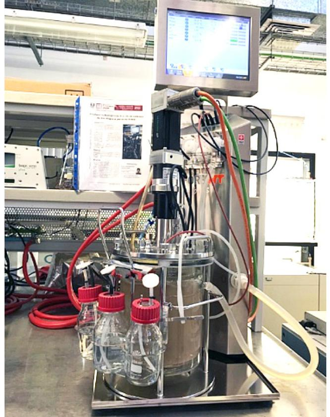
Figura 1. Reactor productor de metano a partir de FORSU
