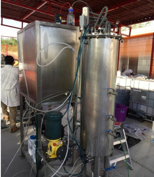
Figura 2. Reactor productor de hidrógeno a partir de efluentes vitivinícolas a escala piloto
