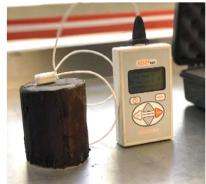
Figura 1. (a) Equipo de la aguja térmica, y (b) curva de ajuste para una prueba de aguja térmica
