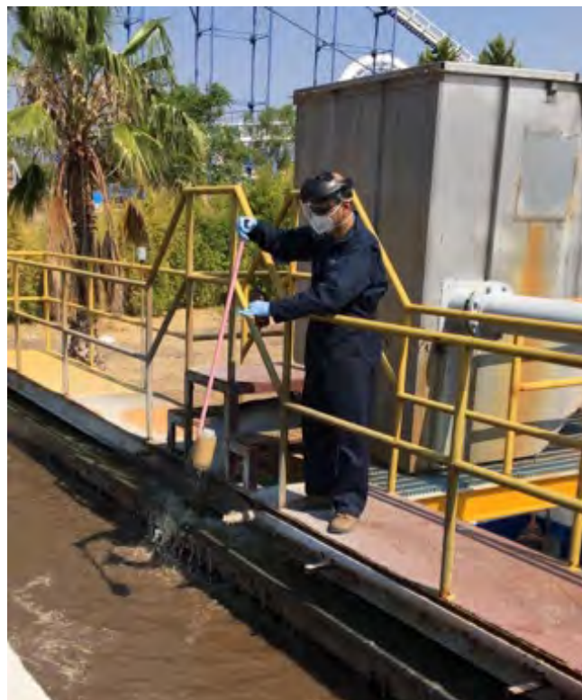
Figura 1. Campaña de muestreo en diferentes plantas de tratamiento de aguas de la Ciudad de Querétaro por personal de la UA Juriquilla del Instituto de Ingeniería. Se analiza la presencia del virus SARS-CoV-2, a partir de su material genético, en diferentes etapas del tren de tratamiento (agua cruda, lodos activados y agua tratada)
