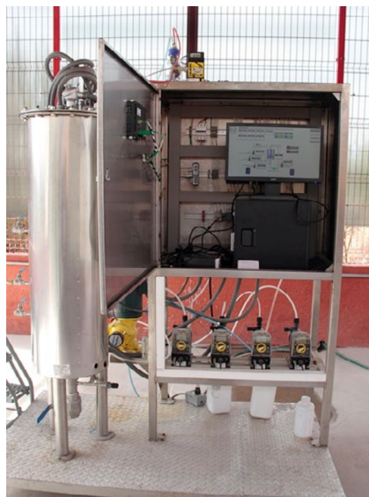
Figura 5. Reactor piloto de 100 L operado como filtro percolador para la producción continua de \text{H}_2
