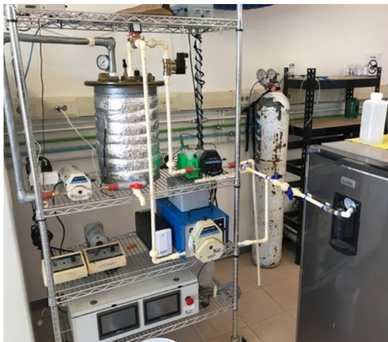
Figura 2. Sistema empleado para la generación de metano a partir de residuos sólidos orgánicos
