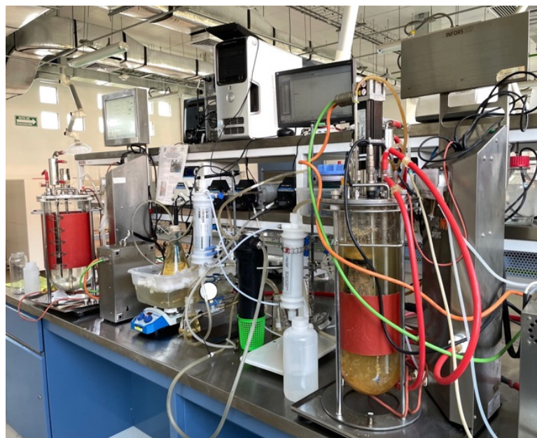
Figura 2. Sistema de producción de ACCM en continuo a partir de efluentes vitivinícolas acoplado con un sistema de extracción en línea
