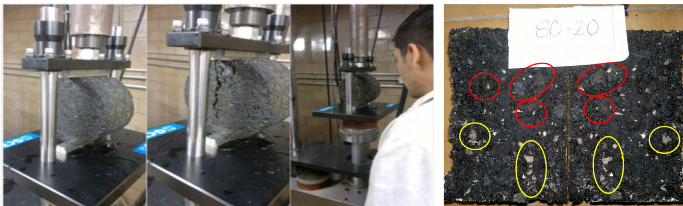
Figura 13. Prueba para determinar la susceptibilidad al daño por humedad en concretos asfálticos con combinación de agregado pétreo y reciclado de RCD 80-20 (Fuente: García-Salas, 2014)
