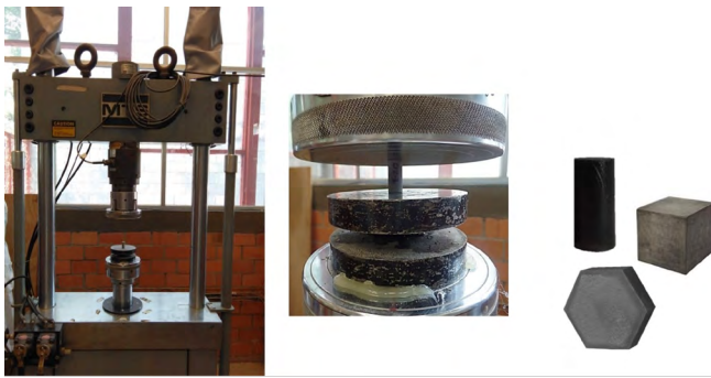
Figura 7. Evaluación del comportamiento mecánico a la compresión de los materiales
