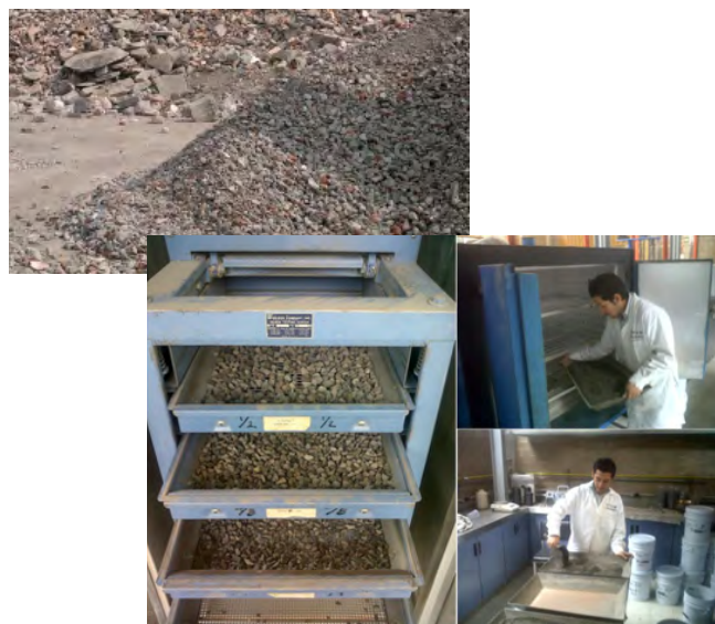
Figura 12. Acopio y separación por tamaños de los RCD (Fuente: García-Salas, 2014)
