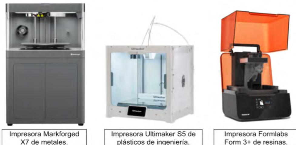
Figura 1. Diferentes tipos de impresoras 3D
