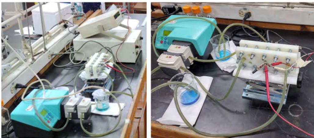
Figura 4. Batería de flujo de vanadio
