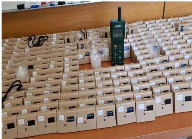
Figura 4. Verificación de los equipos utilizando hielo seco
