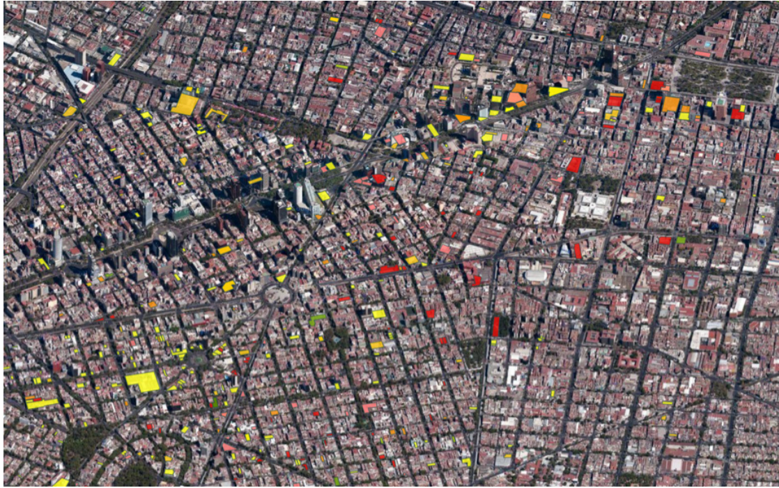
Figura 3. Daños causados por los sismos de 1957, 1979, 1985 y 2017; se indican los predios donde hay o han habido estructuras que han sufrido daño, desde daños menores (amarillo) hasta colapsos (rojo)
