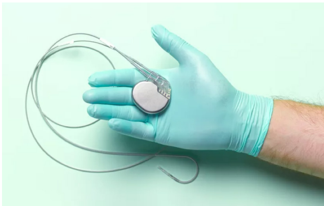
Figura 1. Marcapasos estándar en la mano de un cirujano. Nótese el tamaño pequeño de la unidad central con cubierta de titanio y las largas terminales, aisladas con un polímero, que permiten la conexión eléctrica al corazón (Peter Dazeley / Getty Images)
