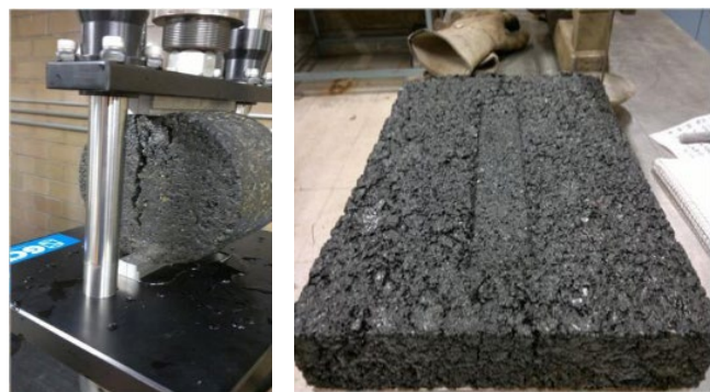
Figura 2. Ejecución de pruebas en concreto asfáltico elaborado con RCD triturado (García Salas, 2014)
