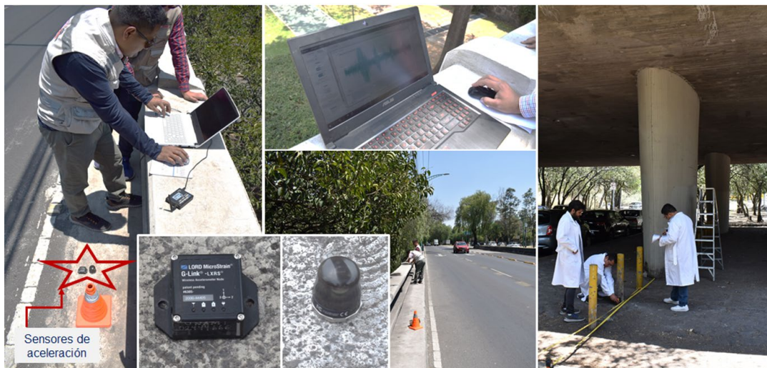
Figura 2. PVA en uno de los puentes vehiculares de CU
