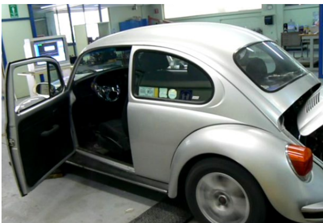
Figura 1. Evaluación vehicular en un dinamómetro de Unidad de Investigación y Control de Emisiones
