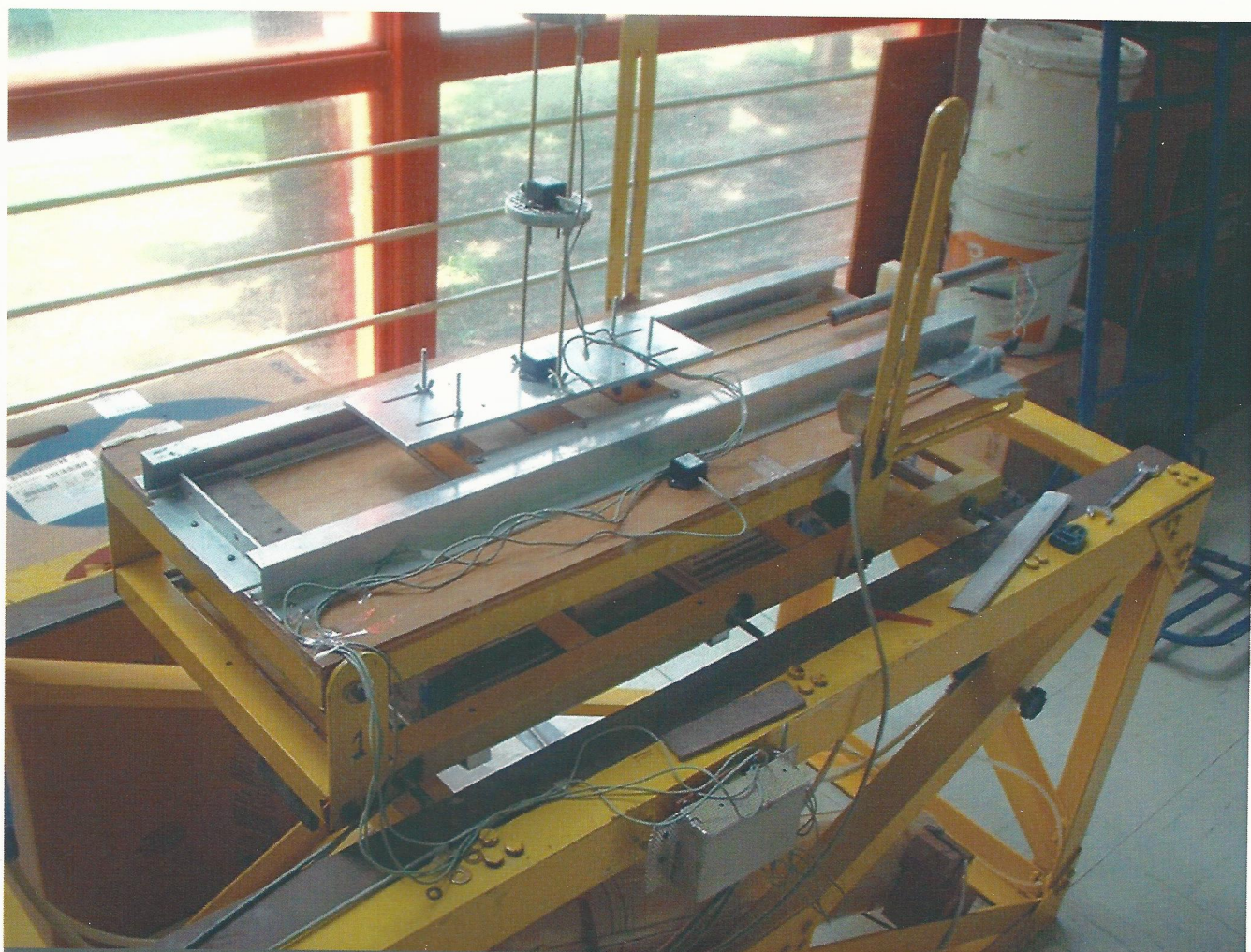
Modelo bidimensional no lineal para el análisis del comportamiento dinámico de estructuras térrreas
