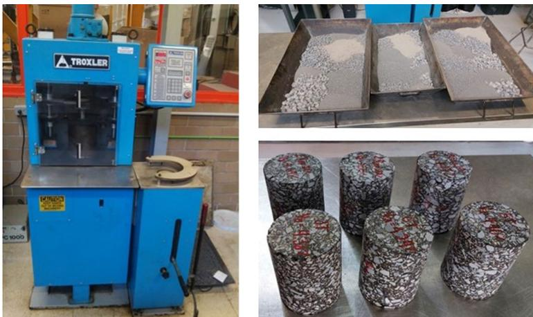
Figura 5. Compactador giratorio SUPERPAVE
