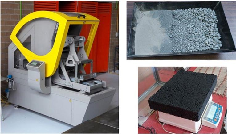
Figura 6 Compactador lineal
