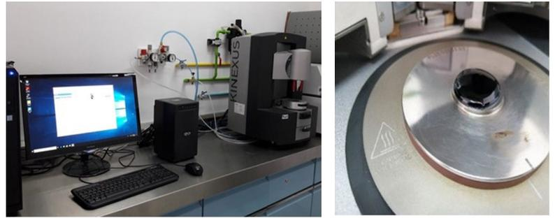
Figura 2. DSR, Reómetro de corte dinámico
