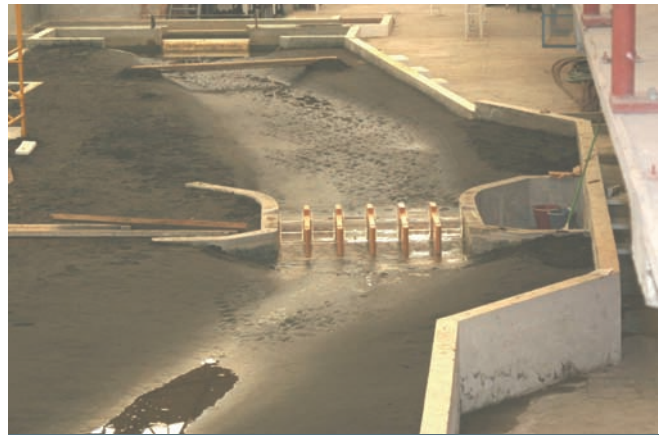
Obra de control, escala 1:40, sobre el río La Sierra
