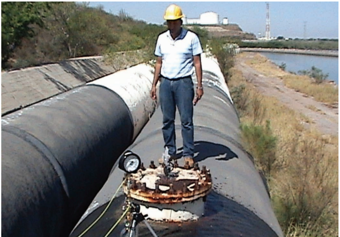
Fotografía de la campaña de medición del gradiente hidráulico en el tramo
