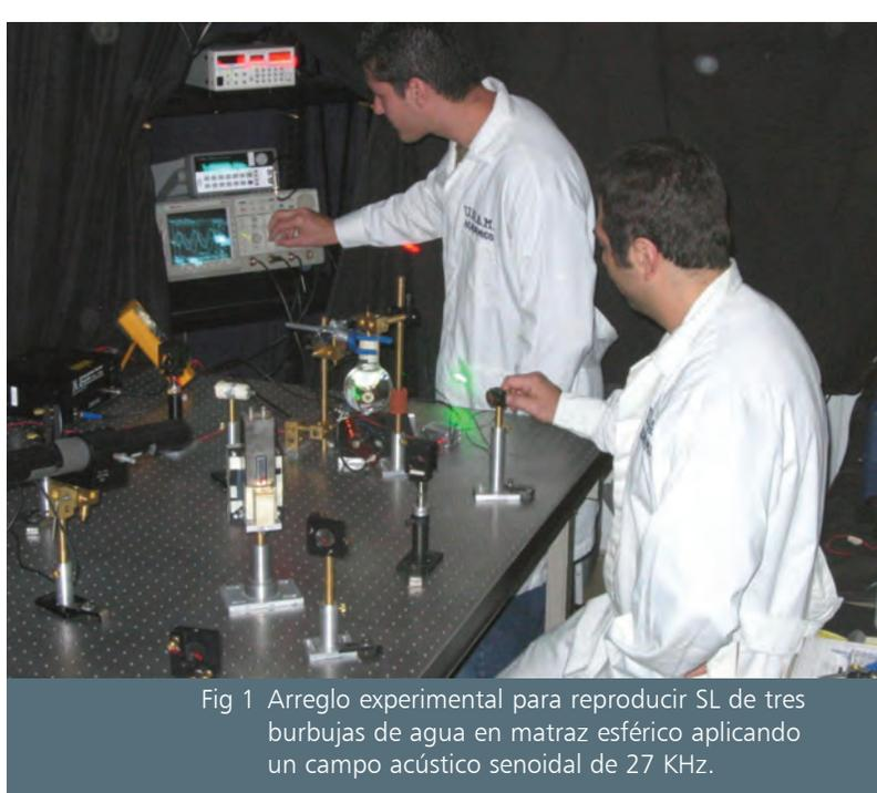
Fig 1 Arreglo experimental para reproducir SL de tres burbujas de agua en matraz esférico aplicando un campo acústico senoidal de 27 KHz.
