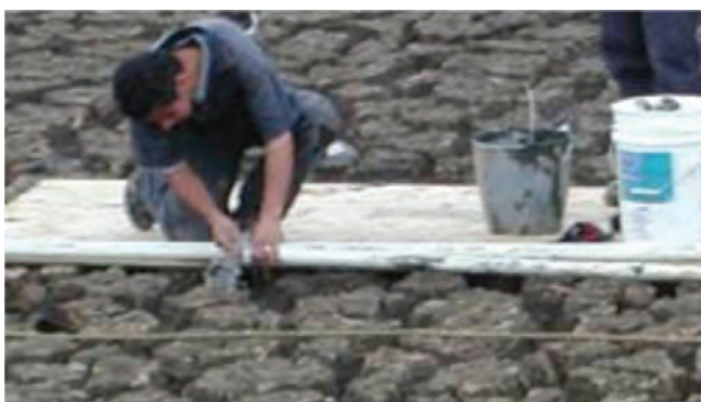
Pruebas de los nucleadores de material de PVC de 1.5 pulgadas de diámetro para el muestreo de los lodos en la tarquina
