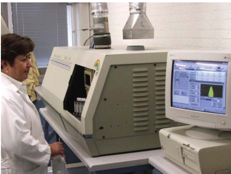
Espectrofotómetro de plasma acoplado inductivamente para detección de metales
