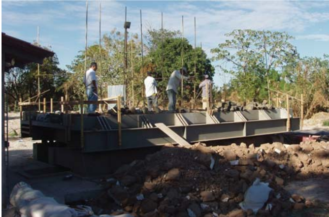
Vista general de la mesa inclinable sobre la que se inicia la construcción del modelo de adobe reforzado con caña
