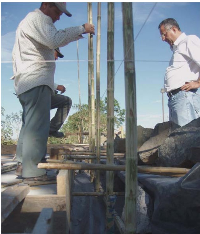
Vista general de la mesa inclinable sobre la que se inicia la construcción del modelo de adobe reforzado con caña
