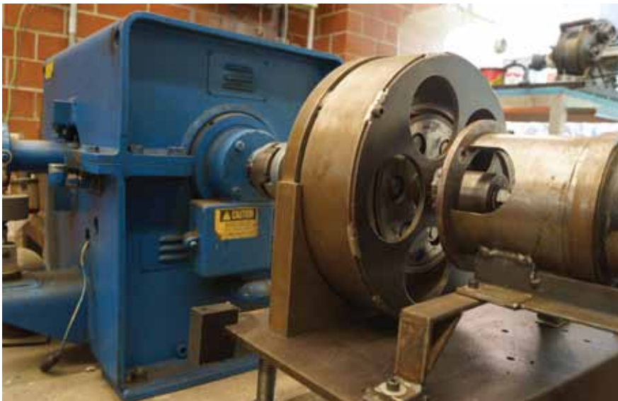
Figura 4. Prueba dinamométrica del reductor
