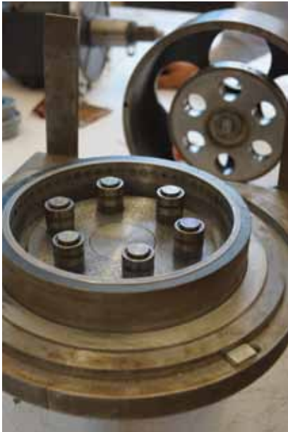
Figura 2. Reductor abierto (se aprecia el plato con los pernos y rodamientos, y el engrane móvil)
