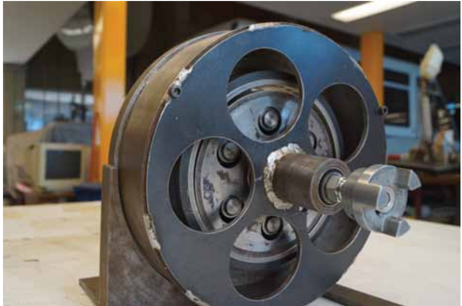
Figura 3. Prototipo de reductor de velocidad magnético
