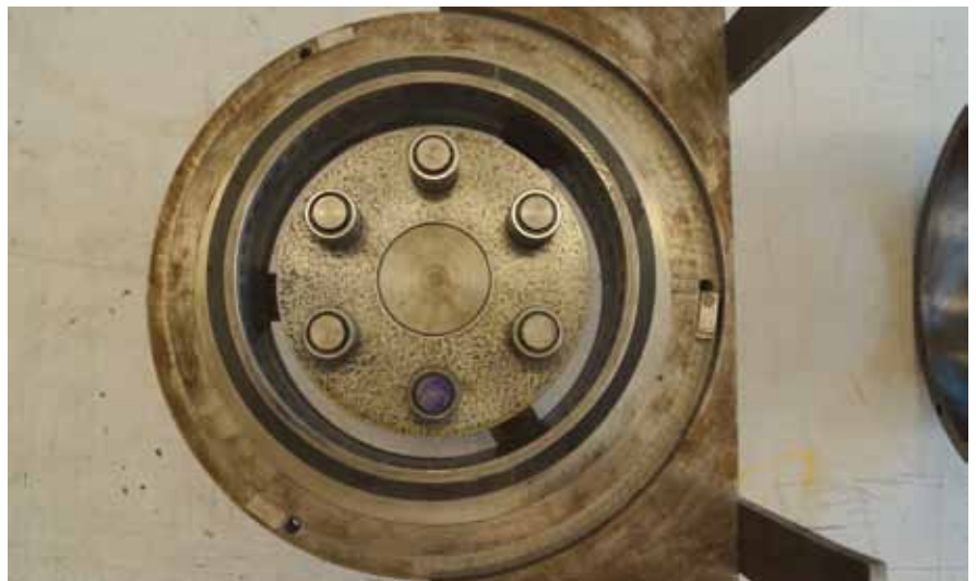
Figura 1. Ensamble parcial del reductor
